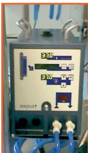
Fig. 6. Intercambiador de calor.
